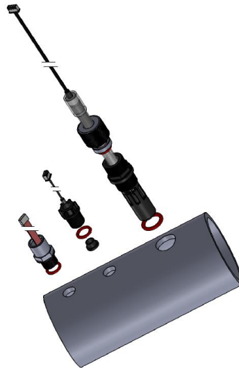
Figura 46 - Installazione delle sonde su tubazione da 3''
